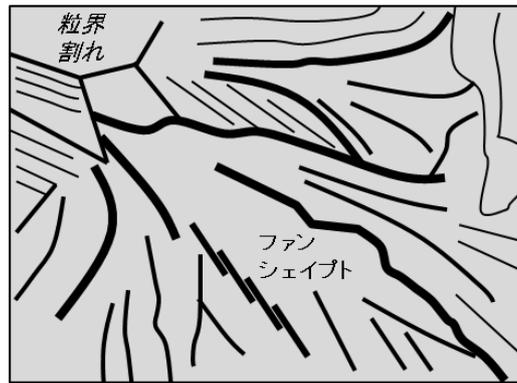
図 14. 応力腐食割れのマイクロ破面と特長
